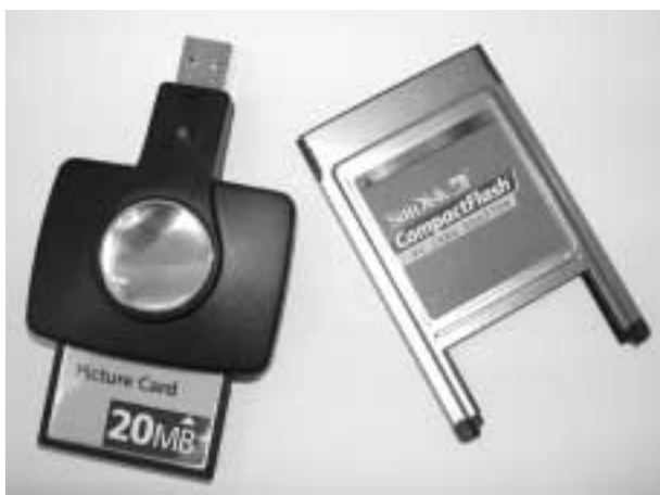
Fig. 2: Tarjeta de memoria de tipo CompactFlash y dispositivo para conexión de las mismas a puerto USB del ordenador (izquierda), o ranuras PCMCIA de ordenadores portátiles (derecha).
